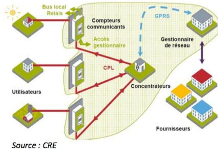
Chaque compteur envoie ses informations vers un concentrateur (une centaine de compteurs environ) via la technologie du courant porteur en ligne (CPL). Ce concentrateur envoie au gestionnaire du réseau (ERDF) via la technologie GPRS (technologie pour les mobiles et même ondes que les mobiles). ERDF dispatche l'information vers les divers fournisseurs d'électricité (EDF, Enercoop, Direct énergie, Engie...)
